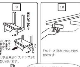
【完全固定をしたい場合は】付属の固定用ネジをL字金具のネジ穴にドライバーでしっかりと固定することでステップとL字金具が完全に固定されます。
