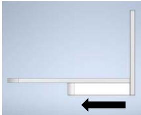
※完全固定ネジを取り付けられている場合はネジを外してからステップを取り外してください。
