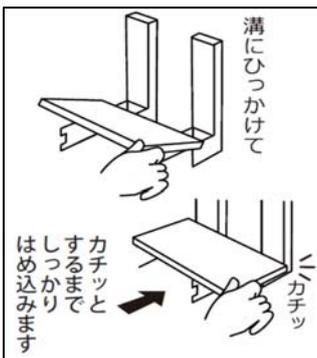
※①でネジを取り外した場合再度ネジを取り付けて下さい
